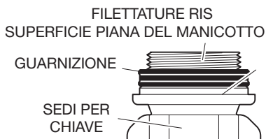
FIGURA 7 MANICOTTO A SALDARE RIS MONTAGGIO DEL MANICOTTO
